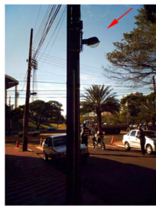
Luminárias instaladas (seta vermelha) em postes nas calçadas de Maringá, PR. Esse sistema provocou a redução das podas na arborização de toda cidade.
