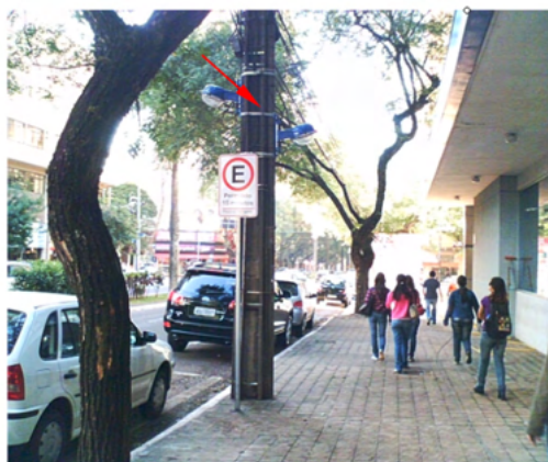
Luminárias instaladas (seta vermelha) em postes nas calçadas de Maringá, PR. Esse sistema provocou a redução das podas na arborização de toda cidade.
